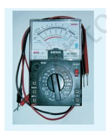
Fig. A 4.1(a) Analog multimeter
